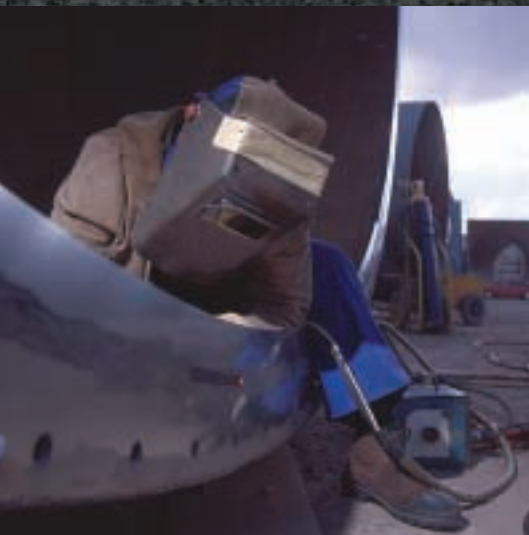
Navařování ochranných vrstev ze slitinové ocele.
