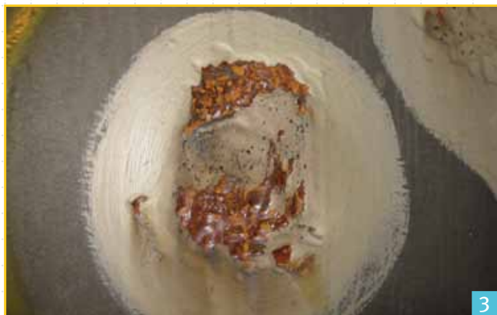
Neu beschichtete Korrosionsstelle – mit erneutem Korrosionsschaden
